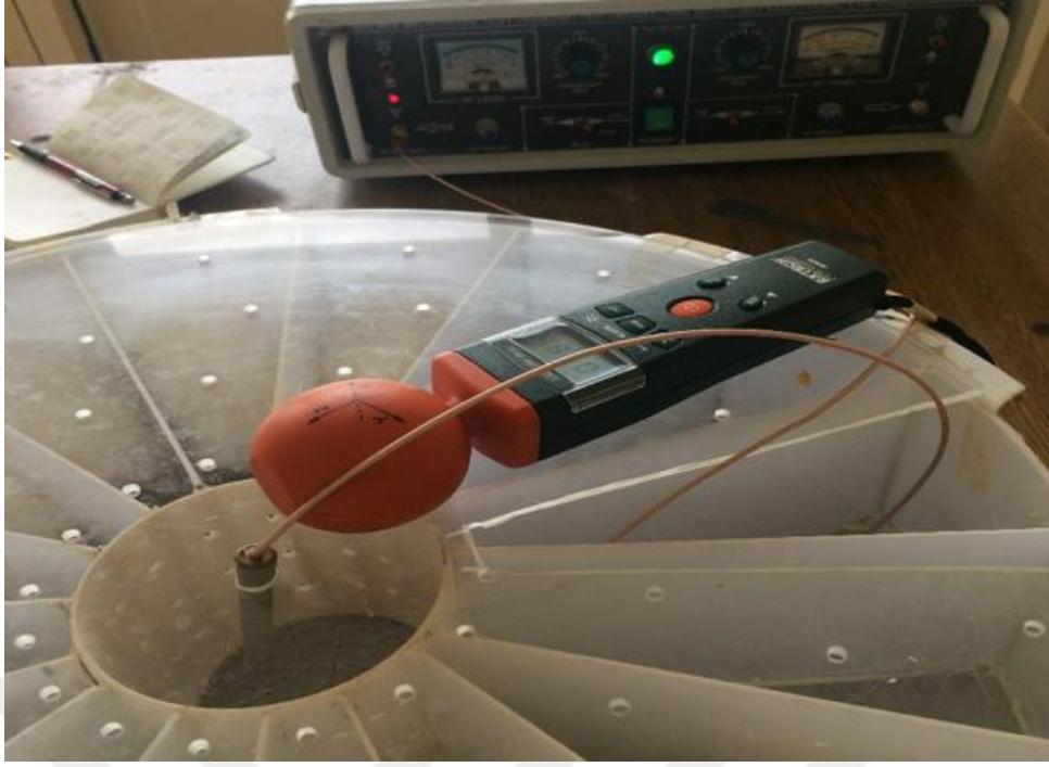
Şekil 3. 900 MHz EMA maruz kalma deney düzeneği ve elektrik alanı ölçüm sistemi
