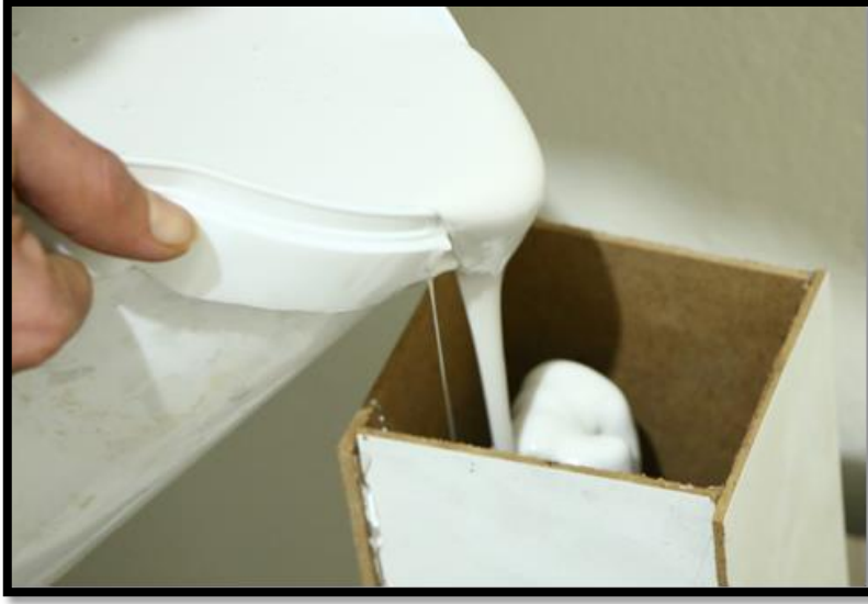
Şekil 17. Sıvı haldeki kalıp silikonunun kalıba dökülmesi
