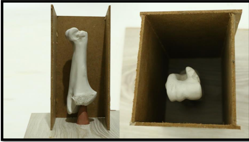
Şekil 16. Sıvı haldeki polyester dökümüne hazır kalıp
