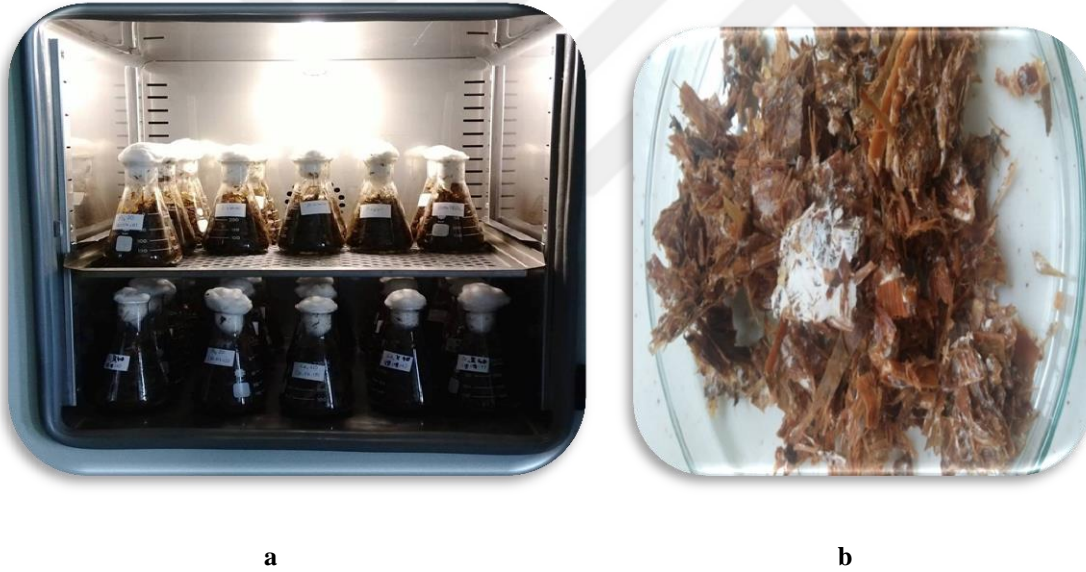
Şekil 4. a,b mantar inokulasyonu yapılan örneklerin inkübatöre konulması ve 10 günlük inkübasyon sonucunda kurutulması
