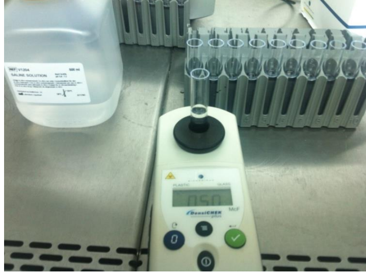
Şekil 14. MİK analizleri için dansitometrede türbiditenin ayarlanması
