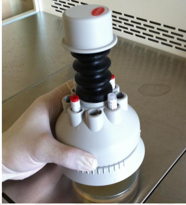
Şekil 13. Antibiyotik disklerinin dispenser aracılığıyla Mueller Hinton agara yerleştirilmesi
