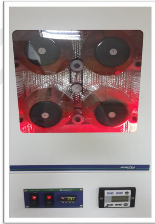
Şekil3.Domates Posası'nın ANKOM Daisyinkübatör'de 48 saat süreyle inkübasyonu
