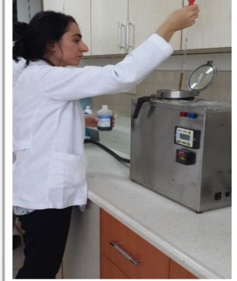
Şekil 5. ANKOM Fiber Analyzer cihazında NDF prosedürünün uygulanması
