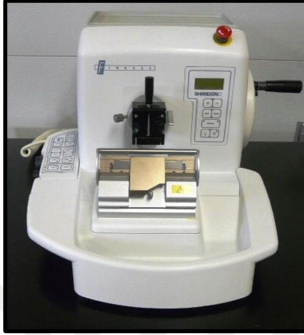
Şekil 22. 500 nm kalınlığındaki kesitlerin alındığı mikrotom (Shandon Finesse ME Microtome, Thermo Scientific) görülmektedir
