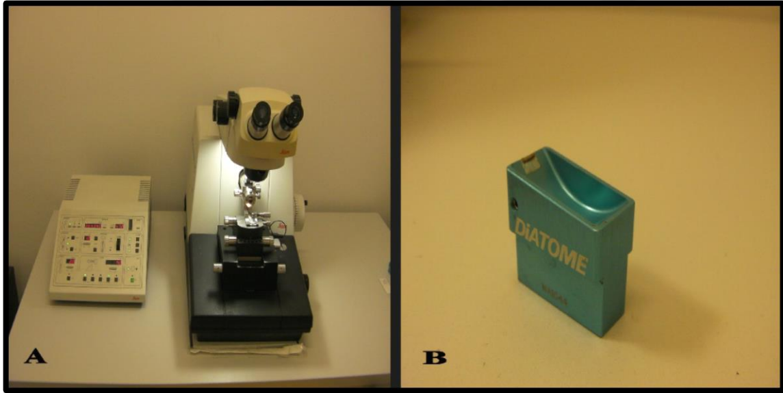
Şekil 21. A. 70 nm kalınlığında kesitlerin alındığı ultramikrotom (Leica Ultracut UCT, Leica Microsystems GmbH, Almanya); B. Ultramikrotomda kullanılan elmas bıçak görülmektedir
