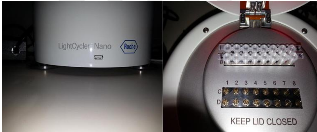
Resim 1. Real time PCR cihazı ve Real Time PCR cihazına tüplerin yerleştirilmesi
