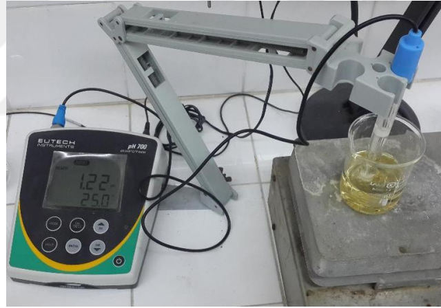
Şekil 20. Ph-metre ile Ph derecesinin ölçümü
