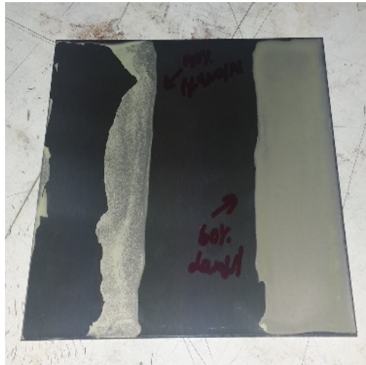
Şekil 46. Solda bir kısmı yüzeyden ayrılan GA ile; sağda ise tam kaplanmış GL ile hazırlanan kaplamalar
