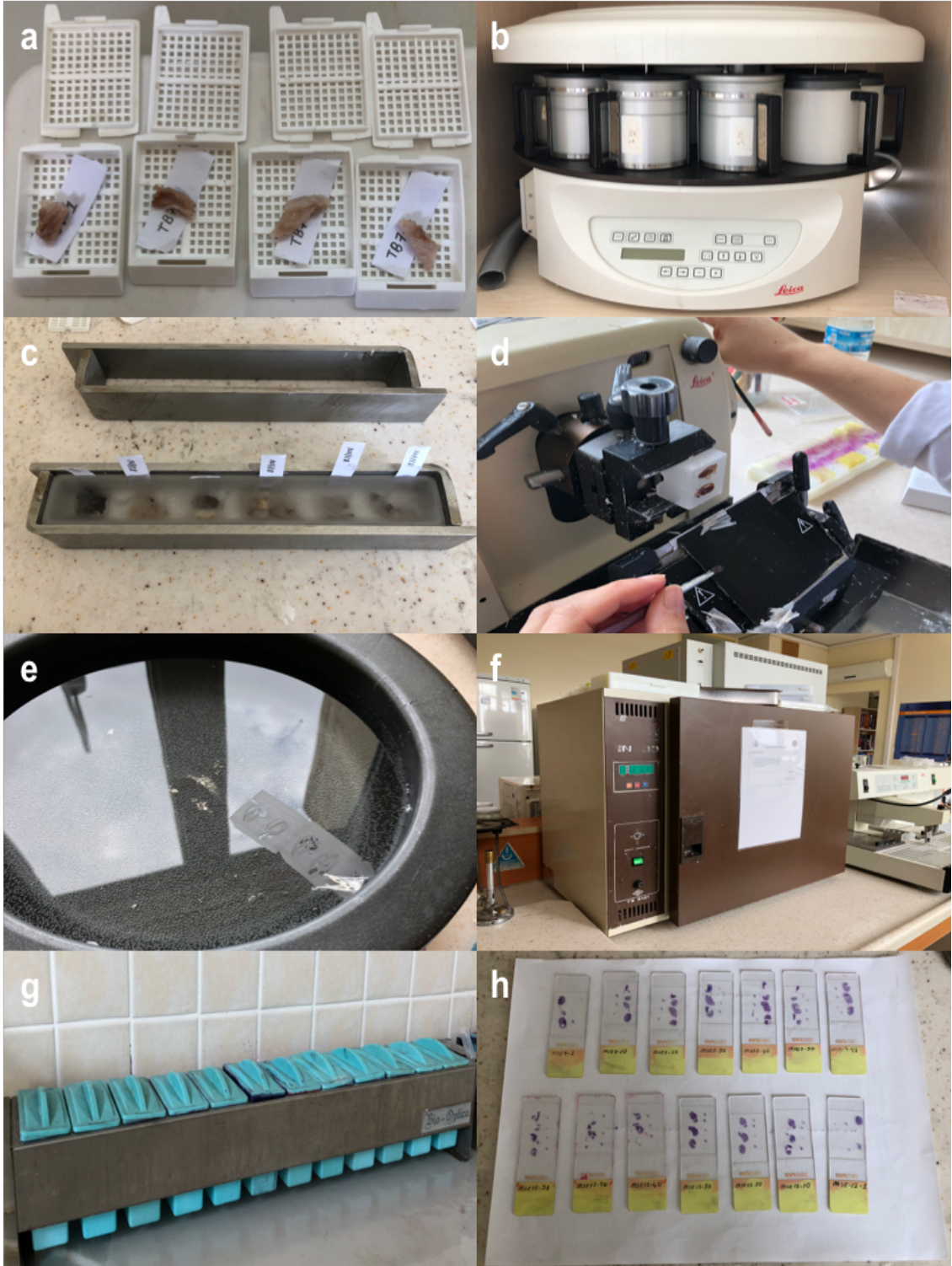
Şekil 60. Preparatların hazırlanması. a: Örneklerin kasetlere yerleştirilmesi, b: Örneklerin yerleştirildiği doku takip cihazı, c: Örneklerin parafine gömülmesi, d: Örneklerin mikrotomla kesilmesi, e: Kesilen örneklerin ılık suda bekletilmesi ve açılmasının sağlanması, f: Parafinin uzaklaştırıldığı etüv cihazı, g: Hematoksilen - eozin boyamada kullanılan solüsyon serisi, h: İncelemeye hazır preparatlar
