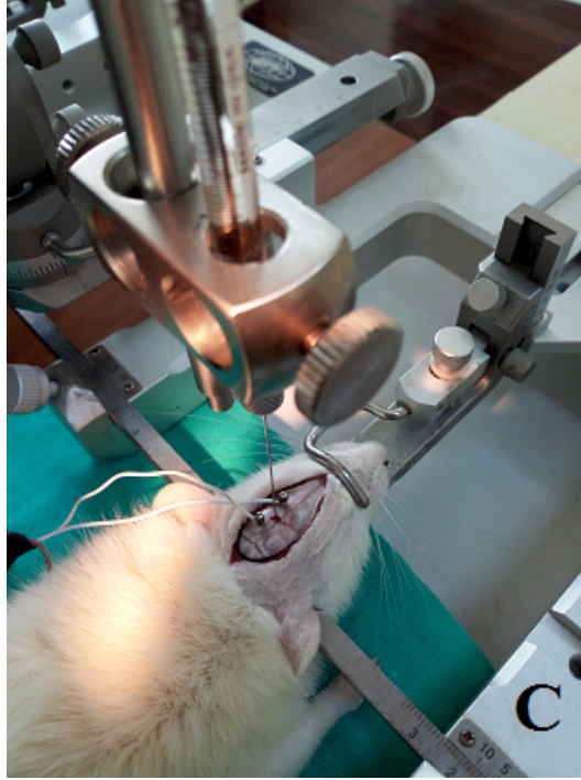
Şekil 13. C. Sıçan kafatası kemiği üzerindeki vidalara elektrot bağlantısı ve Hamilton mikroyenjektör ile intrakortikal enjeksiyonun yapılması
