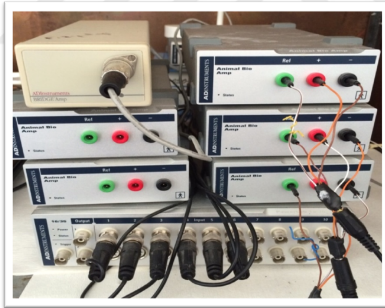
Şekil 16. 16 kanallı Powerlab veri kazanım sistemi ve bağlantıları
