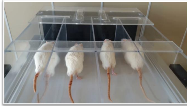
Şekil 8. May time 0804 4 kulvarlı ayarlanabilir eğimli treadmill
