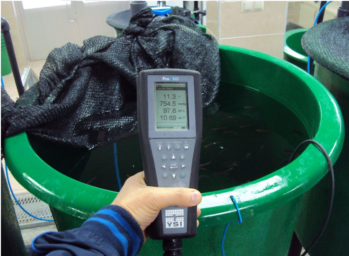
Şekil 5. Yetiştirme suyu sıcaklığı ve oksijen değerleri
