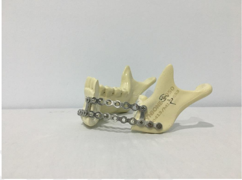
Şekil 19. 6 delik boyutunda defekte uygulanan kendi dizaynımız olan plak
