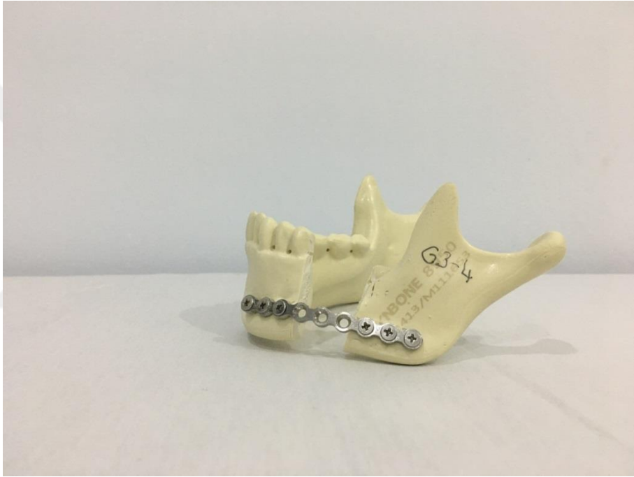
Şekil 15. 3 delik boyutunda defekte uygulanan düz plak
