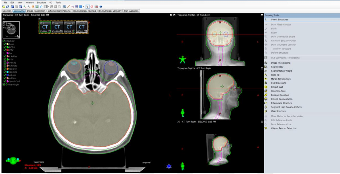
Şekil 5. Eclipse TPS’de Hedef Volüm ve OAR’ların Konturlanması
