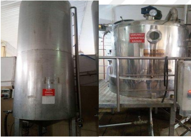
Şekil.3.Vakumlu kaynatma kazanı ve son ürün tankı
