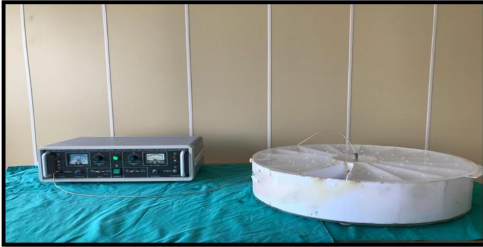
Şekil 14. EMA maruziyet sistemi (Sinyal jeneratörü ve yuvarlak plastic kafes)
