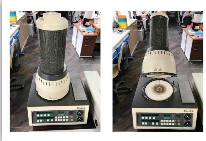
Şekil 7. Press-on tekniğinde kullanılan ısı-basınç fırını.
