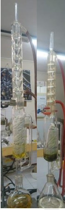
Şekil 7. Soxhlet cihazı ile Inula viscosa yaprak ve çiçeğinden ekstrakt alma
