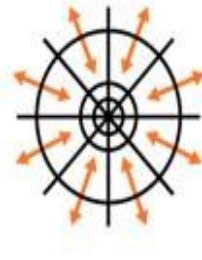
Şekil 3:Yukarıdan-aşağıya, aşağıdan-yukarıya, dairesel veya ışınsal olarak yapılacak muayene (Memeder, 2020)
