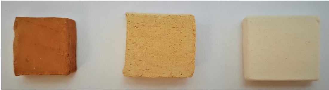
Şekil 7: Kırmızı, şamot ve beyaz vakumlu çamur deneme plakaları.
