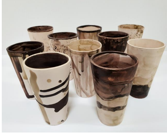
Şekil 16: Farklı oranlarda SGK ile hazırlanmış sırın seramik yüzeylerdeki uygulamaları.
