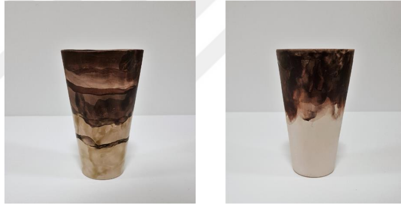
Şekil 15: Farklı oranlarda SGK ile hazırlanmış sırlın seramik yüzeylerdeki uygulamaları.
