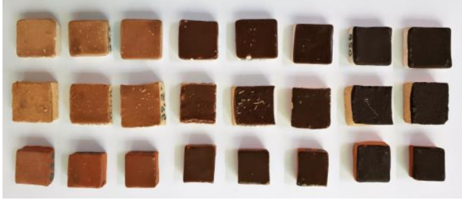
Şekil 112: %0,5-%5 arasında değişen oranlarda SGK katkısı ile hazırlanmış sırların sırasıyla döküm, şamot ve kırmızı çamur deneme plakaları üzerindeki görüntüsü.
