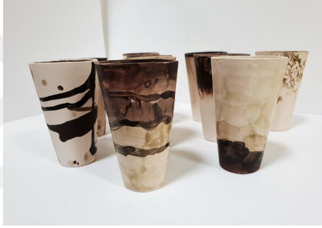
Şekil 17: Farklı oranlarda SGK ile hazırlanmış sırın seramik yüzeylerdeki uygulamaları.
