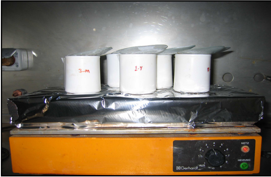
Şekil 5.7. Sediman Örneklerinin Toplam Metal Analizi için Sindirim İşlemi
