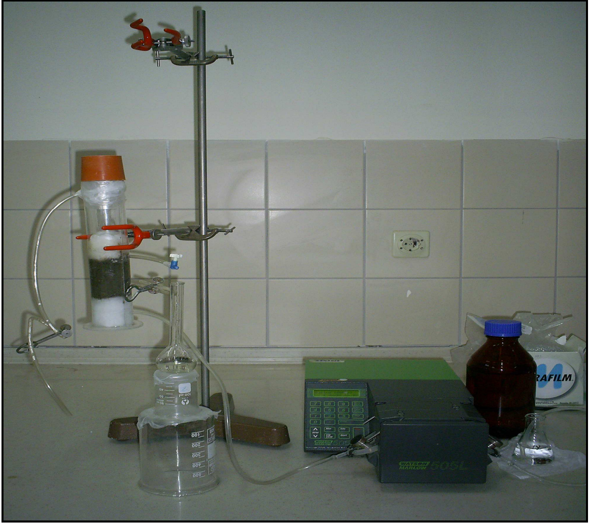
Şekil 5.12. Kirlenmiş Sedimanlardan Ağır Metal Giderimi İçin Kullanılan Sürekli Sistem Deney Düzenegi
