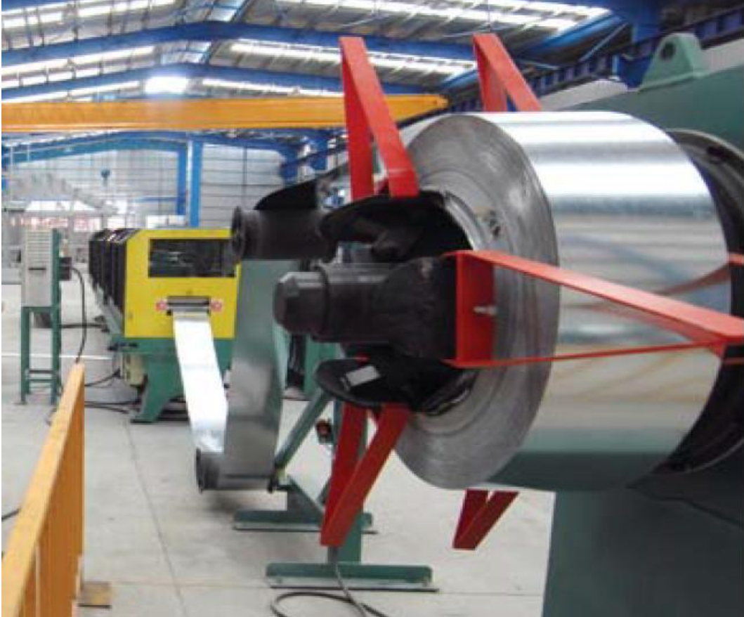
Şekil-2.7: Çelik çekme makinesinde saç profillerin imalata hazırlanması
