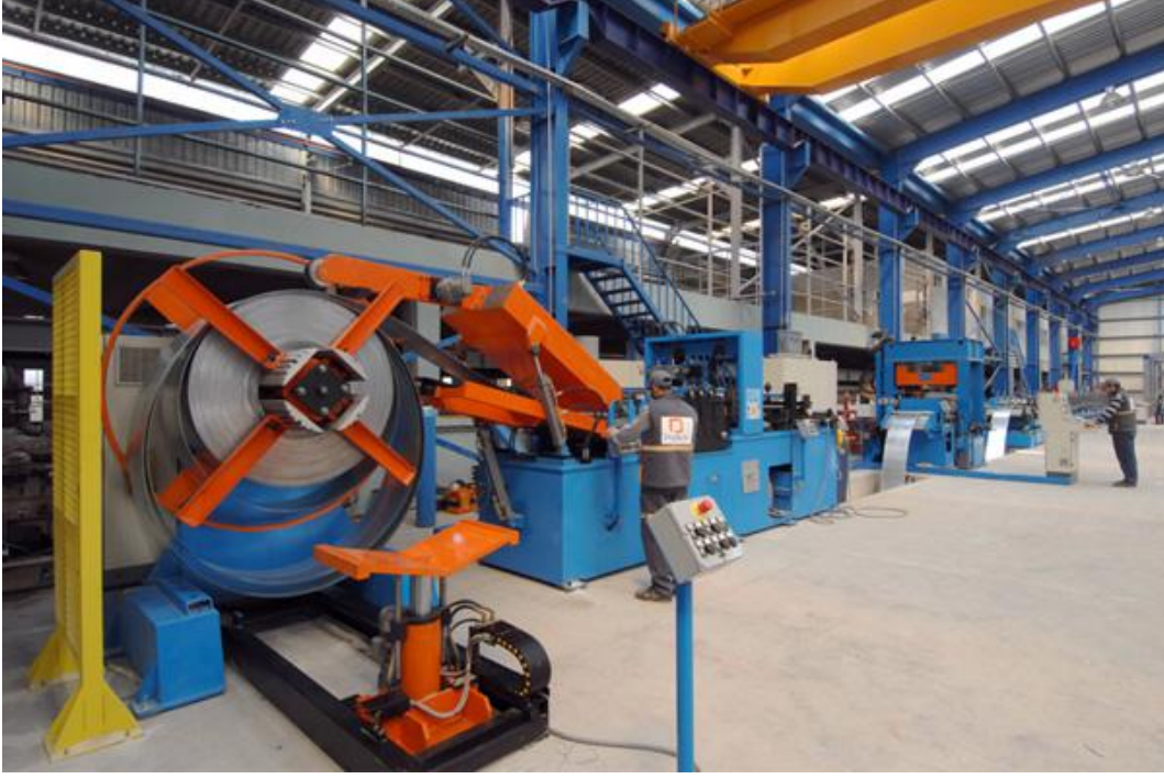
Şekil-2.6: Çelik çekme makinesinde saç profillerin çekilmeye hazırlanması
