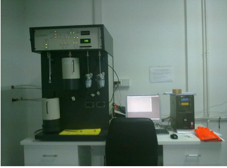
Şekil 3.1. UNIDO-ICHET Laboratuvarındaki BET analiz cihazı
