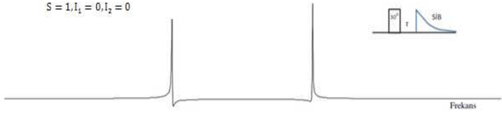
Şekil 4.2. Uygulama 2: S = 1 ve I_1 = 0 ve I_2 = 0 sistemi. \theta = 30^\circ pulsu uygulandıktan ve peşinden \tau = 10 ns beklendikten sonra alınan SİB sinyalinin Fourier dönüşümü frekans uzayındaki spektrumu verir (spektrumda faz düzeltmesi yapılmamıştır, dolayısıyla soğurma veya dağılma spektrumu olmasının bu aşamada önemi yoktur). Spektrum dipolar etkileşmeden dolayı iki enerji düzeyine yarılmakta, dolayısıyla iki geçiş çizgisi oluşturmaktadır
