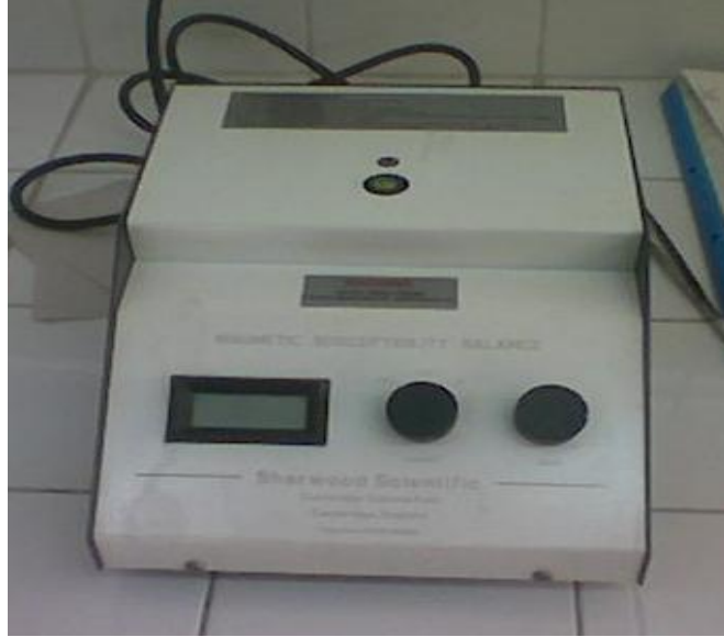
Şekil 2.4. MX I Model Sherwood Scientific manyetik duyarlılık terazisi
