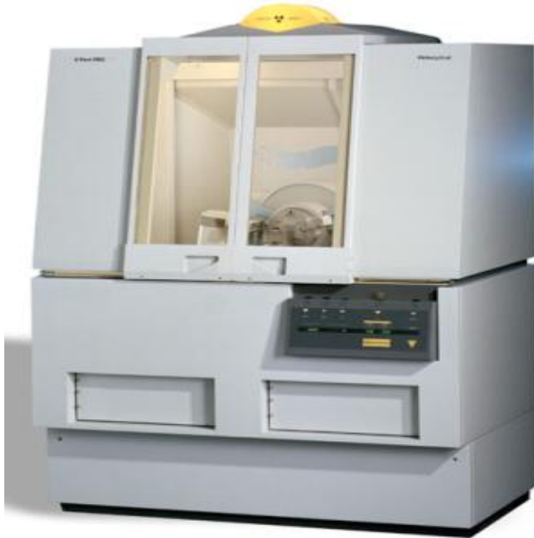
Şekil 2.5. Pananalytical marka X'pert Pro MPD model çok amaçlı X-ışını toz kırınım cihazı
