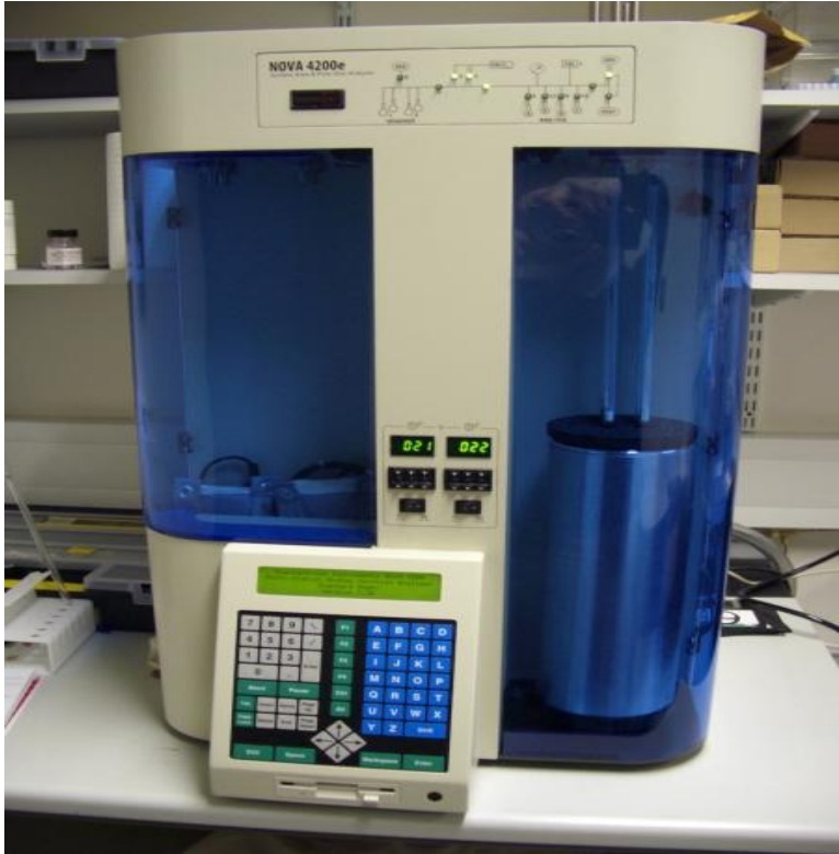
Şekil 2.8. Yüzey alanlarının belirlenmesinde kullanılan Quantachrome Instrument Nova4200e cihazı
