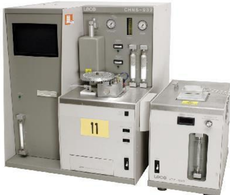
Şekil 2.1. CHNS-932 (LECO) marka elementel analiz cihazı
