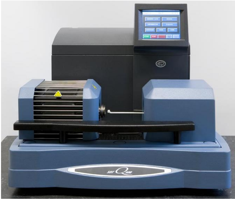
Şekil 2.3. TA Instruments SDT Q600 model termik analiz cihazı
