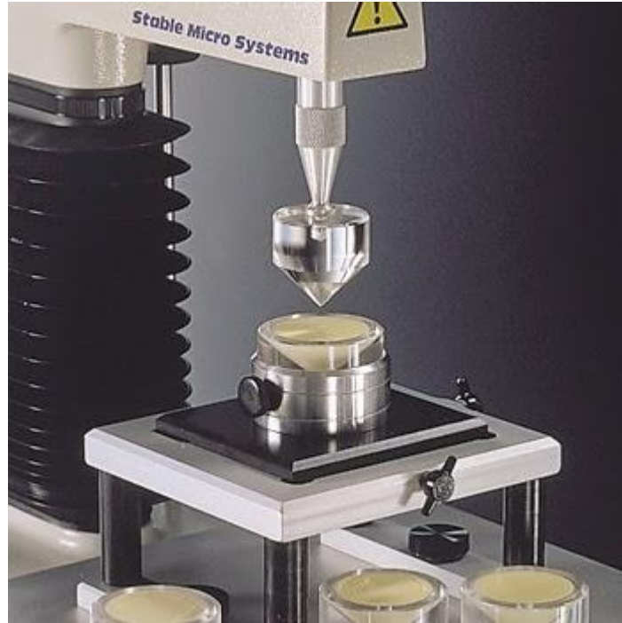
Şekil 3.2. Sürülebilirlik analizinde kullanılan donanım (HDP/SR kodlu donanım).
