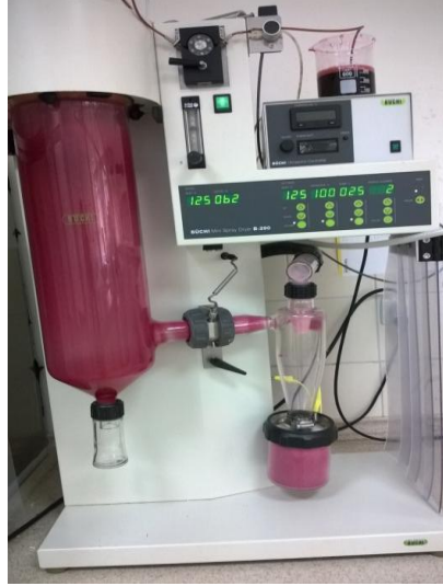
Şekil 2.13. Mini püskürtmeli kurutucuda böğürtlen meyvesinin kurutulması.
