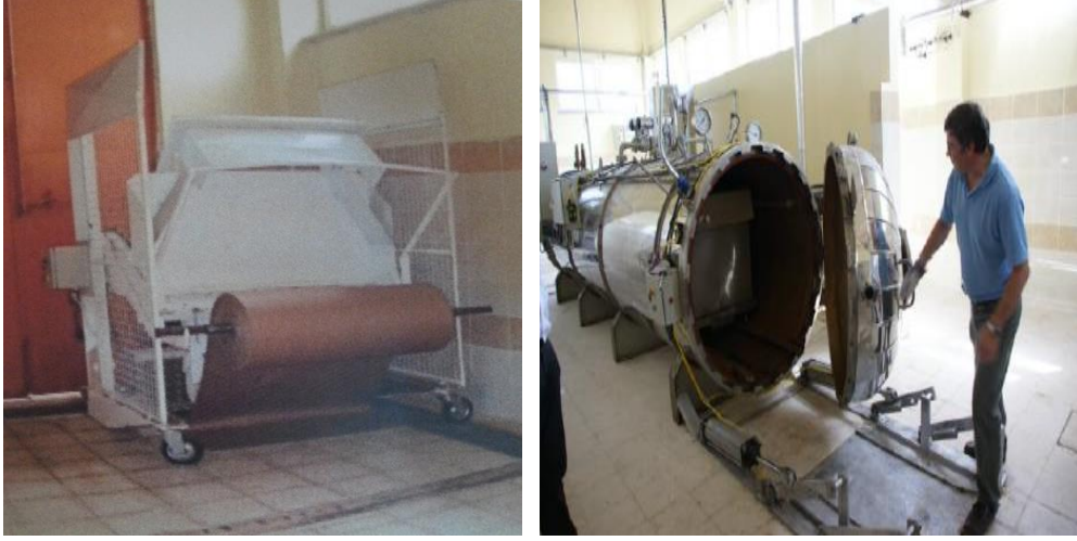
Şekil 3.9. Tıbbi atık sterilizasyon ünitesi.
