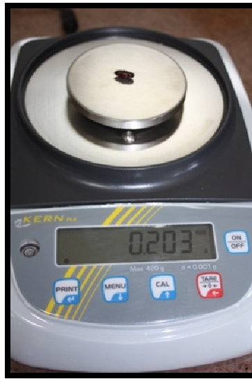
Şekil 3.6. Pupaların ağırlıklarının ölçülmesi için kullanılan hassas terazi
