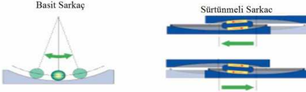
ekil 4.4. Sürtünmeli sarkaç tip izolatörlerin çalış ma prensibi [98]
