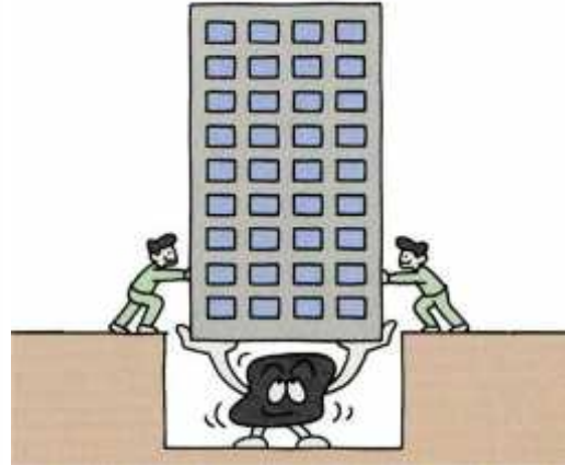
ekil 3.2. Taban izolasyon sistemi [26]
