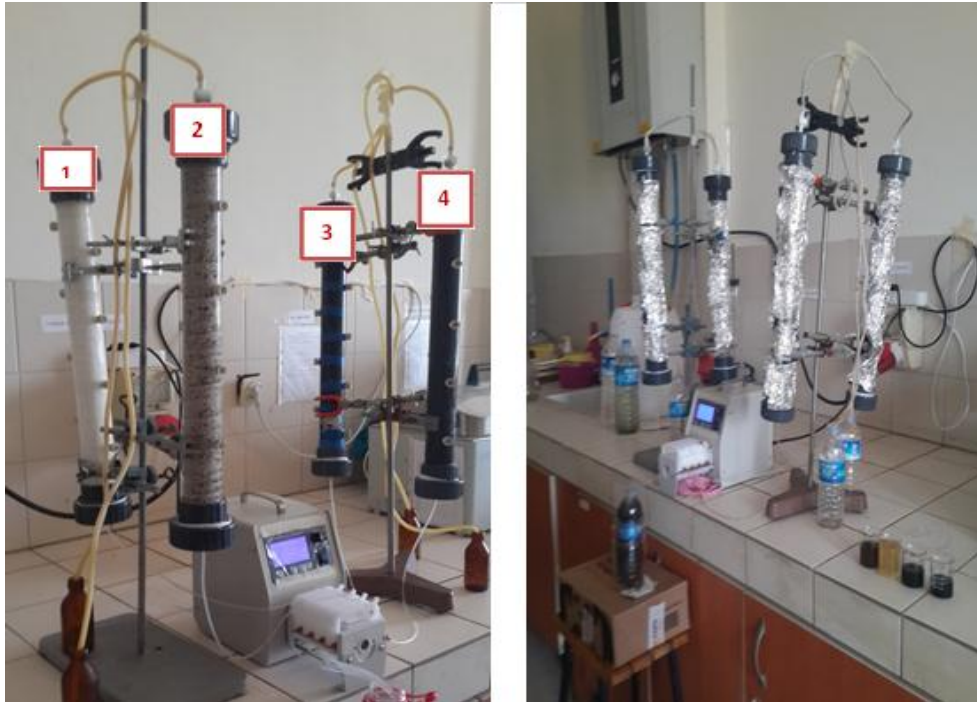
Şekil 3.1. Kolon çalışması deney düzeneği, (1) SE kolonu, (2) PMZ kolonu, (3) VC kolonu, (4) AK kolonu
