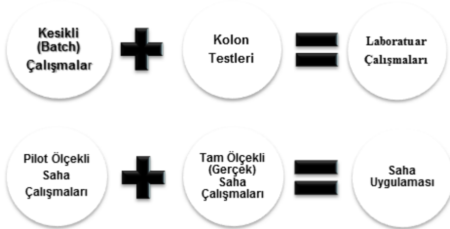
Şekil 2.7. Geçirimli reaktif bariyer sistemlerinin uygulama aşamaları
