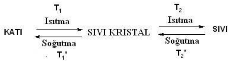
Şekil 2.65. Sıvı kristal geçiş şeması ( T_1, T_1' :erime noktası, T_2, T_2' :berraklaşma noktası)
