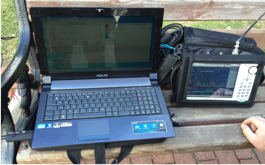
Şekil 3.16. RTL2832U R820T ve Anritsu ölçüm cihazı ile yapılan ölçümler
