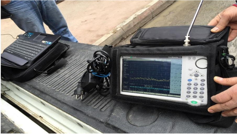
Şekil 3.17. RTL2832U R820T ve Anritsu ölçüm cihazı ile yapılan ölçümler
