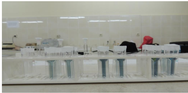
Şekil 3.35. Toplam fenolik madde analizinde spektrofotometre okumasına hazır örnekler
