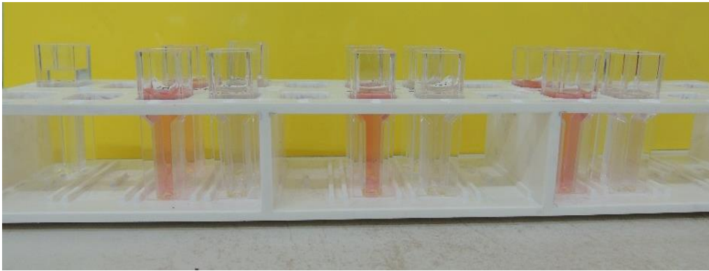
Şekil 3.40. Toplam antosiyanin analizinde spektrofotometre okumasına hazır örnekler
