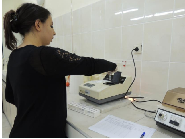
Şekil 3.36. Toplam fenolik madde analizinde spektrofotometrede okuma
