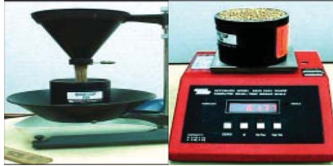
Şekil 3.3. Hektolitre ağırlığı ölçümünde kullanılan cihazlar
