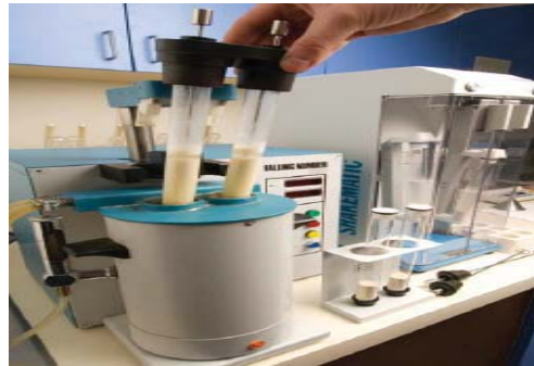
Şekil 3.8. Düşme sayısının belirlenmesinde kullanılan cihaz
