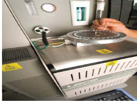
Şekil 3.7. Protein içeriğinin belirlenmesinde kullanılan leco cihazı
