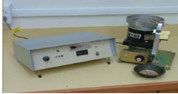
Şekil 3.4. Bin tane ağırlığının belirlenmesinde kullanılan cihaz
