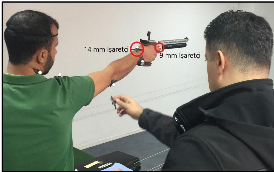
Şekil 5.3. Uygulamada kullanılan 14 mm ve 9 mm yansıtıcı işaretçiler
