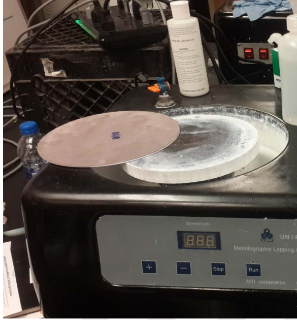
Şekil 2.36. Otolitlerin parlatılmasında kullanılan parlatma kağıdı ve düzeneği
