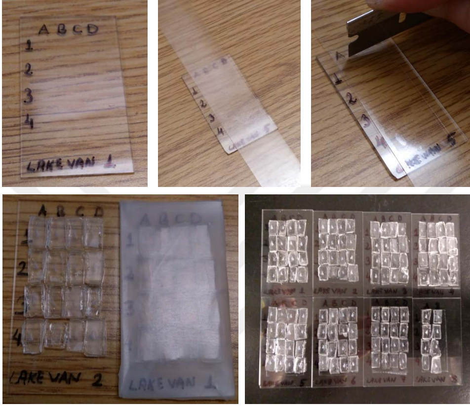
Şekil 2.43. Otolit kesitlerinin kimyasal lamlara yerleştirilmesi işlem basamakları
