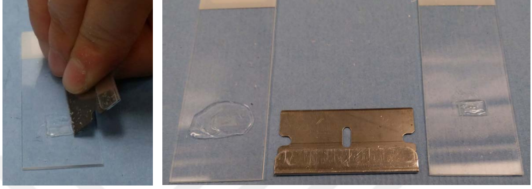
Şekil 2.42. Lamlar üzerindeki kristal bondun uzaklaştırılması işlemi (soldaki lam; kristal bond uzaklaştırılmadan önceki, sağdaki lam: kristal bond uzaklaştırıldıktan sonraki lam görüntüleridir)
