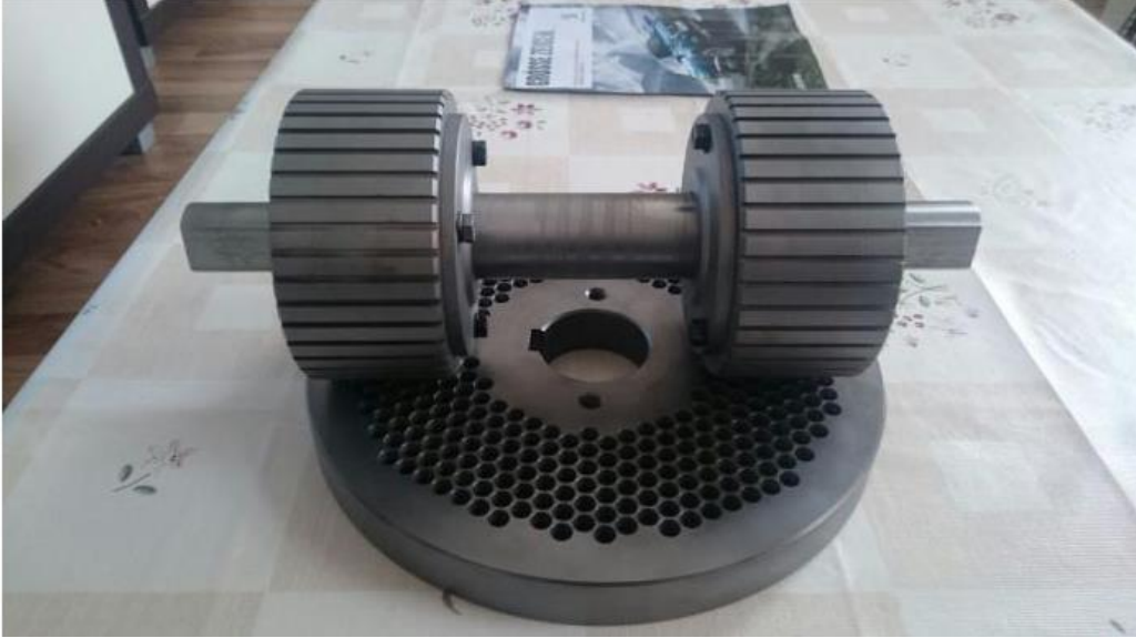
Şekil 4.4. Pelet yapımında kullanılan disk ve röle
