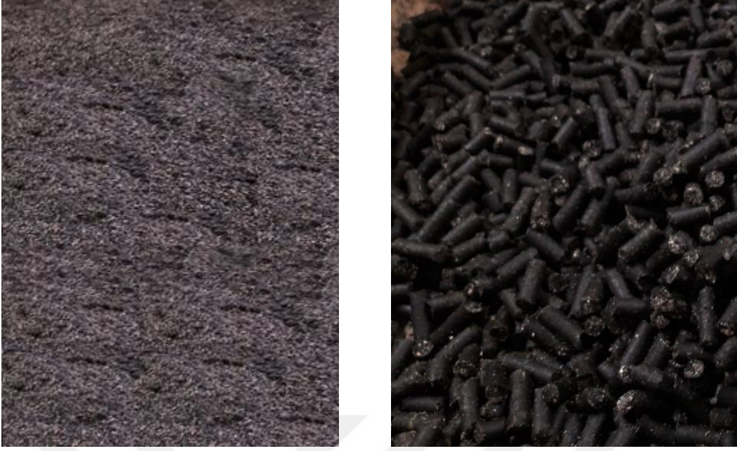
Şekil 4.3. Toz karışımlar (solda) ve pelet hali (sağda)
