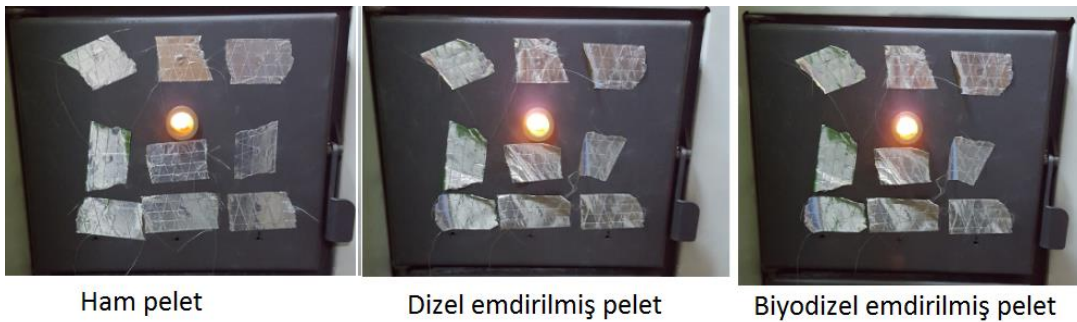
Şekil 5.8. Ham pelet ve emdirilmiş peletler için gözetleme camından çekilmiş alev görüntüleri (Kazan-1)
