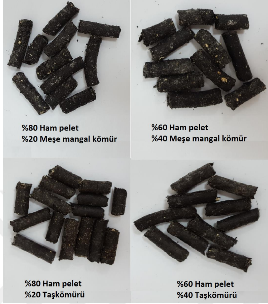
Şekil 5.4. Ham pelet-Kömür karışımlarının görüntüsü
