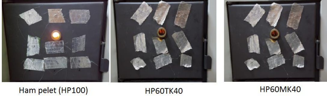
Şekil 5.17. Ham pelet-Kömür karışımlarının gözetleme camından çekilmiş alev görüntüleri (Kazan-1)
