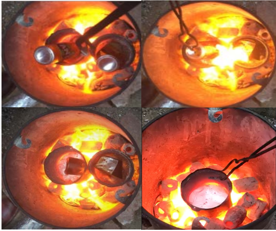
Şekil 4.16. Alüminyum içecek kutularının boya tabakasının yanması ve kutuların ergitilmesi
