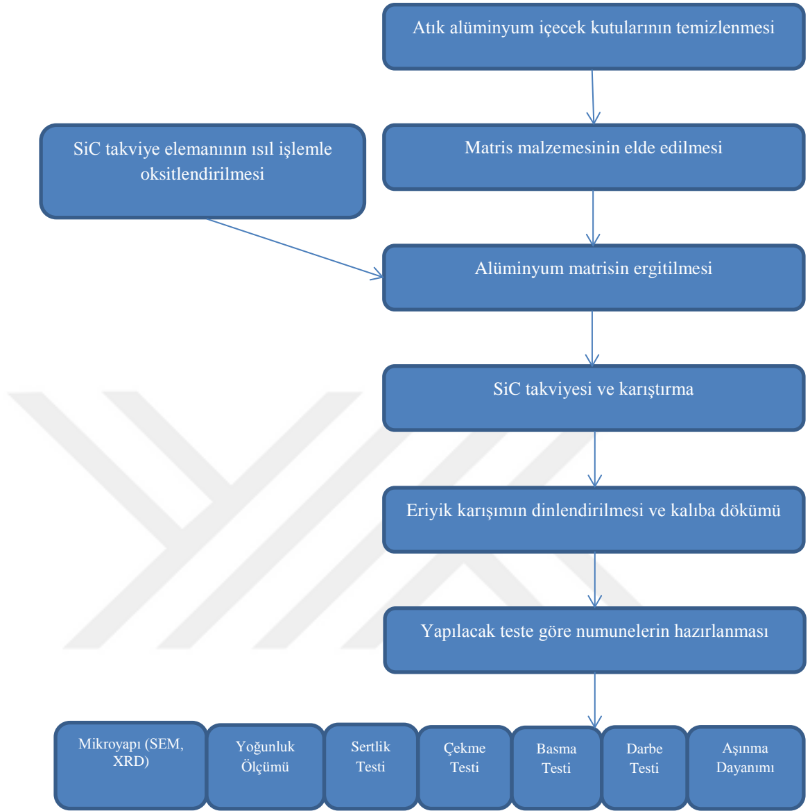
Şekil 4.20. SiC takviyeli kompozit üretimi akış şeması
