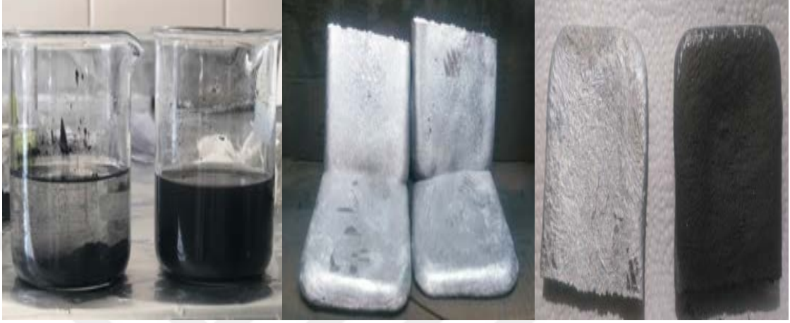
Şekil 4.21. Grafen etil alkol karışımı ve alüminyum külçelerin grafenle kaplanması
