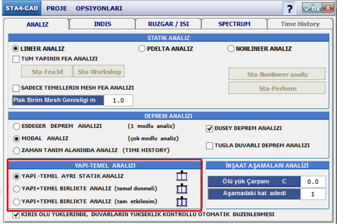
Şekil 3.5. Sta4cad yapı-temel analiz opsiyonları
