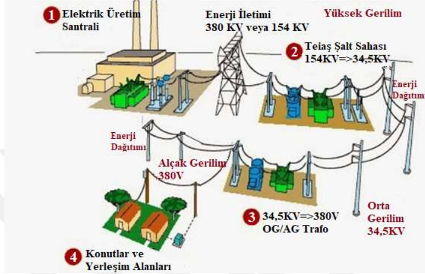
Şekil 3.1. Elektrik güç sistemleri bileşenleri
