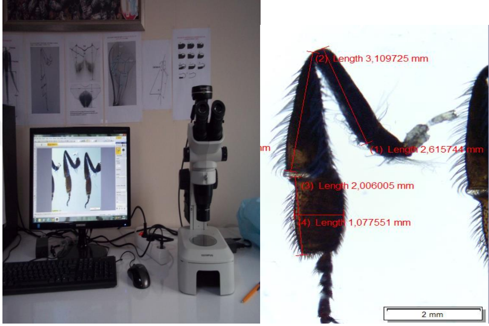
Şekil 3.23. Üst sağda femur uzunluğu (1), tibia uzunluğu (2), metatarsus uzunluğu (3) metatarsus genişliği (4) ölçüm sınırlarının görünümü
