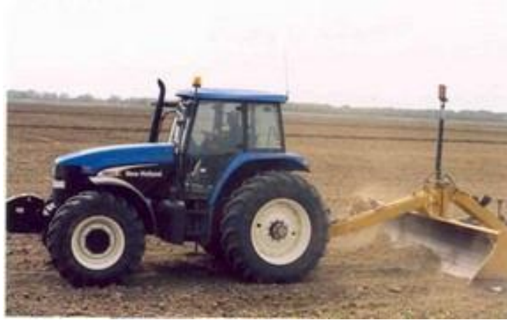
Şekil 1.6. Lazer kontrollü tesviye aleti ile arazi tesviyesi (Sezer ve Akay, 2011)
