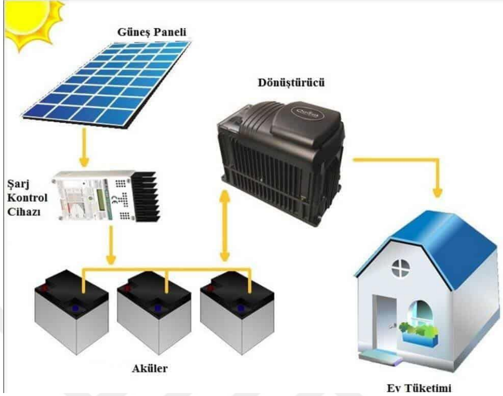
Şekil 2.4 Şebekeden bağımsız fotovoltaik sistem
