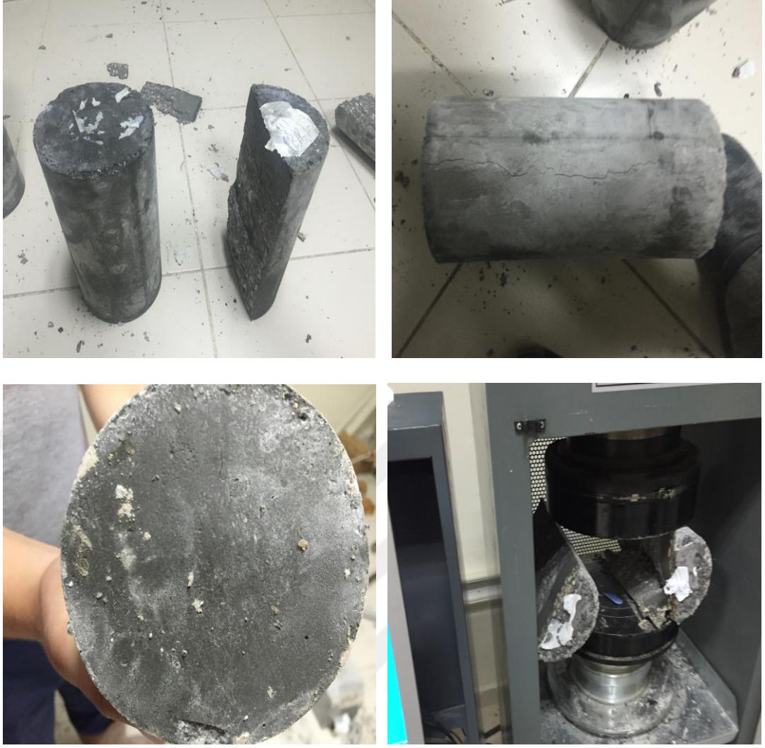
Şekil 6.17. Yarmada çekme deneyinde, ayrılan ve bütün kalan numune örnekleri
