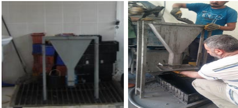
Şekil 5.7. V-hunisi aleti ve deneyin uygulaması
