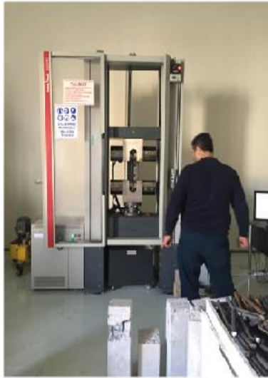
Şekil 5.17. Beton-donatı aderans deneyine ait resimler
