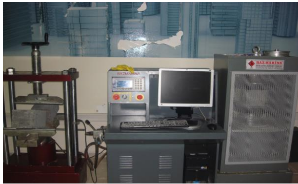
Şekil 5.11. Beton basınç ve kiriş eğilme deney aleti
