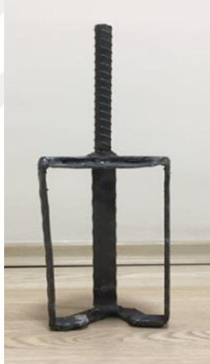
Şekil 5.17. Beton-donatı aderans deneyine ait resimler
