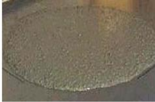
Şekil 6.2. Yapılmış bir serbest yayılma deneyi
