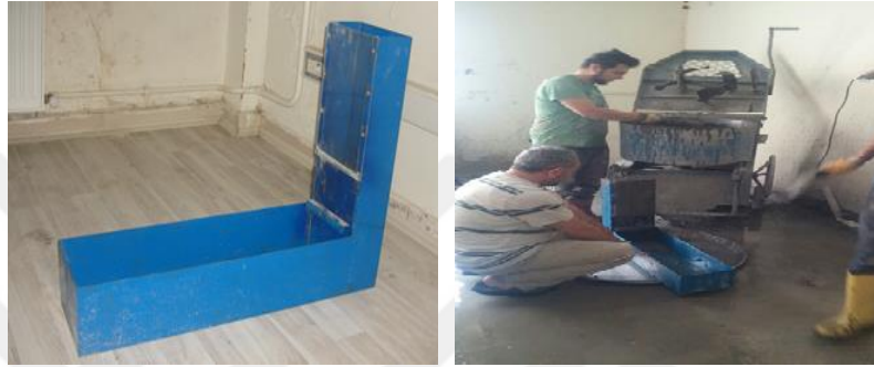
Şekil 5.8. L-kutusu aleti ve deneyin uygulanışı
