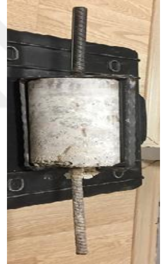
Şekil 5.17. Beton-donatı aderans deneyine ait resimler
