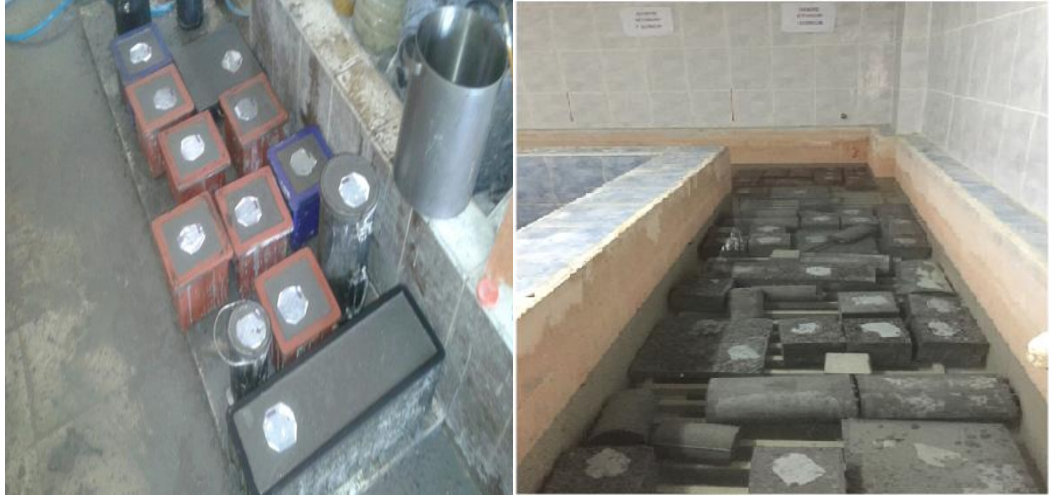
Şekil 5.10. Kalıplara yerleştirilmiş ve kür havuzunda bazı beton numuneler
