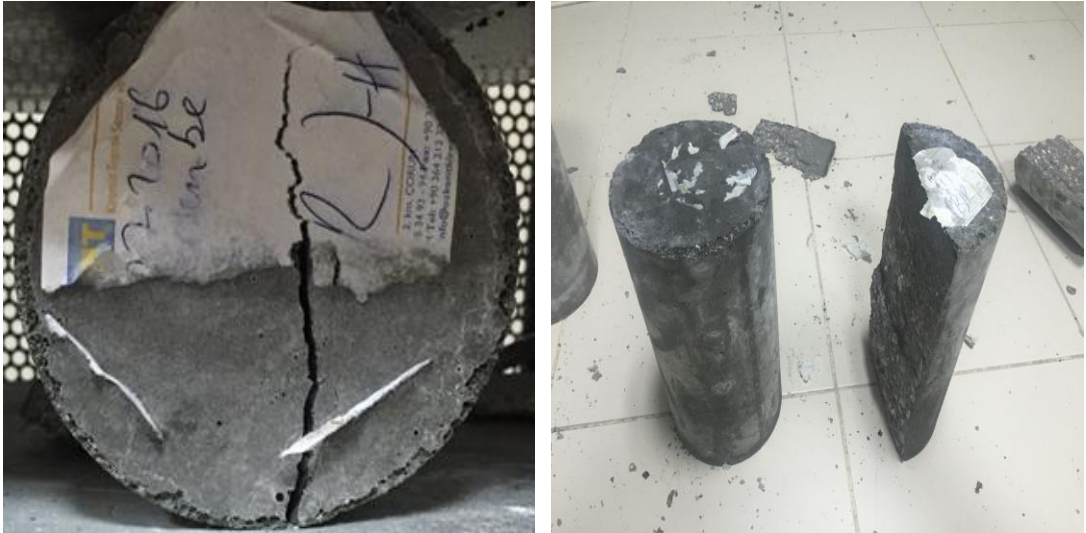
Şekil 5.12. Yarmada çekme deneyi (silindir numune)
