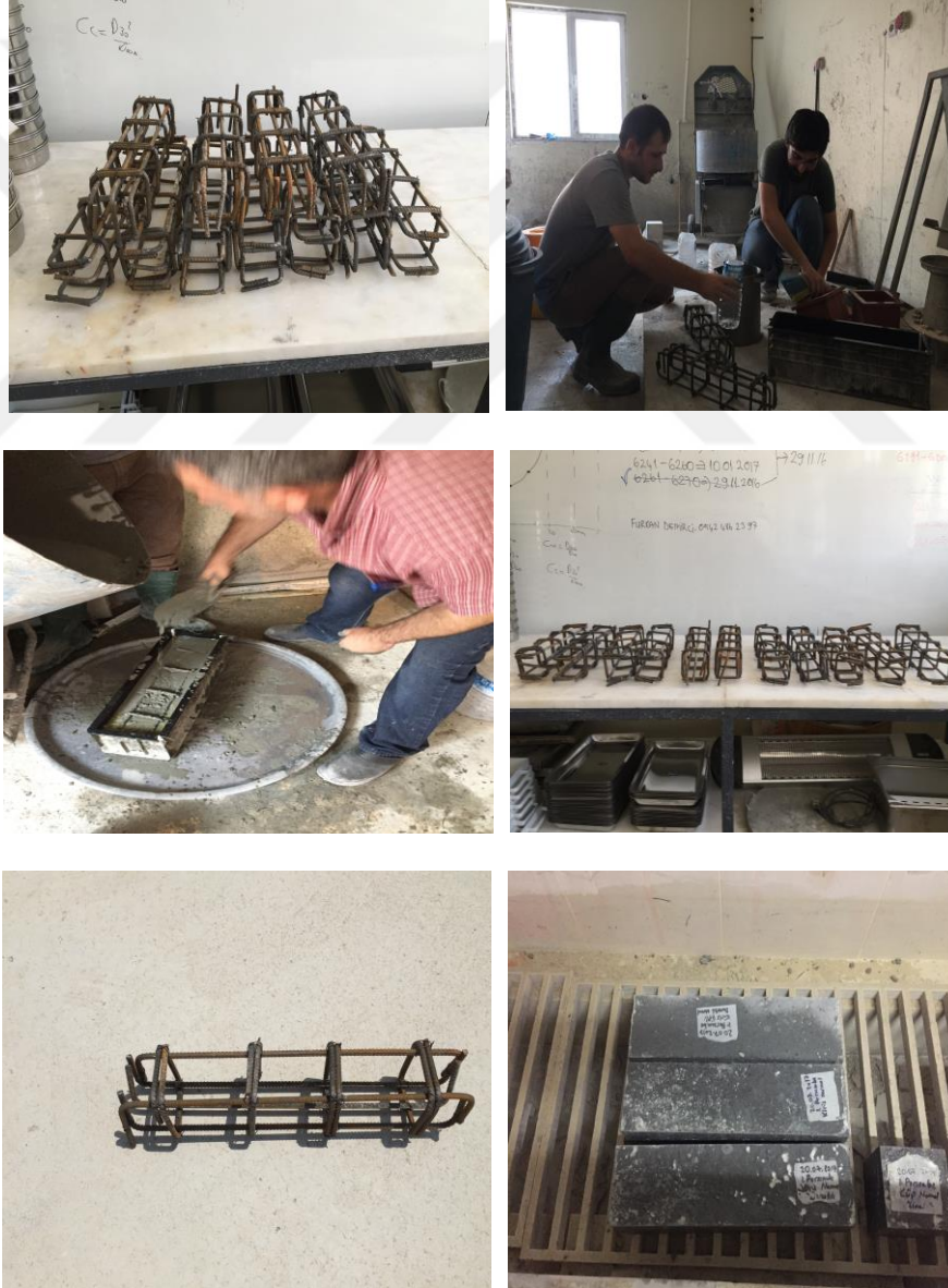
Şekil 5.16. Betonarme küçük kirişlerin laboratuvar ortamında üretimi
