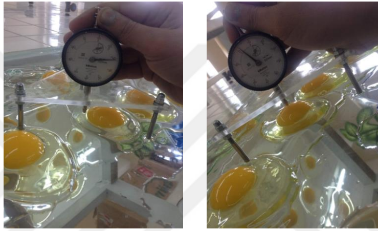
Şekil 3.6. Ak ve sarı yüksekliği ölçüm aleti ile ölçümler
