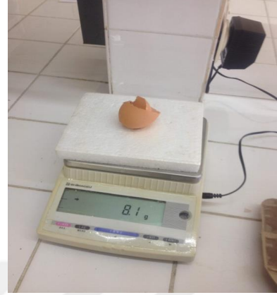
Şekil 3.8. Yumurtaların hassas terazi ile sarı ağırlığı ve kabuk ağırlığının belirlenmesi
