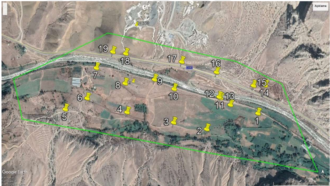
Şekil 3.5. İşhan çalışma sahası yer kontrol noktaları
