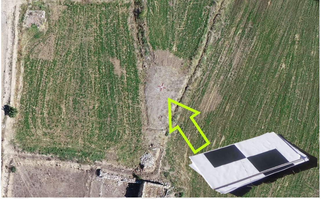
Şekil 3.4. İşhan çalışma sahası yer kontrol noktası levhaları
