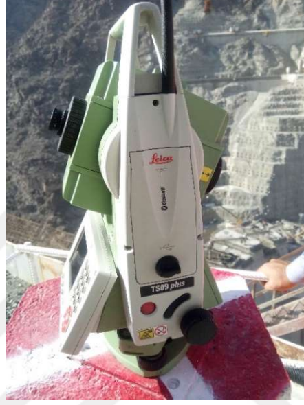
Şekil 3.11. Baraj çalışma sahası Leica TS09 Plus ile YKN ölçümü
