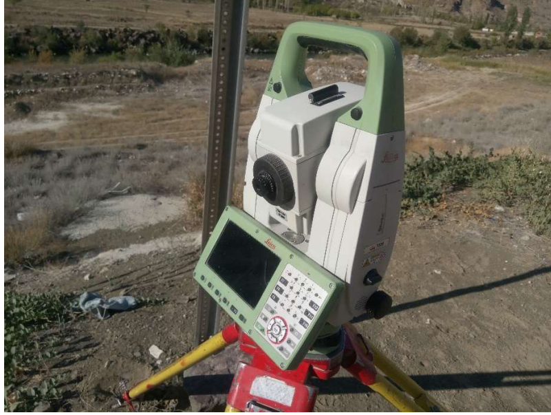
Şekil 3.6. İşhan çalışma sahası Leica Viva TS16 ile YKN ölçümü
