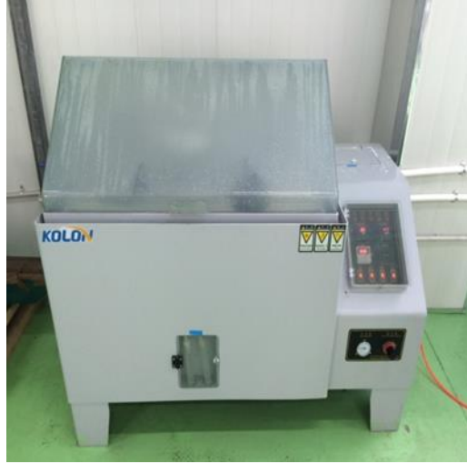
Şekil 2.24. Tuz testi cihazı
