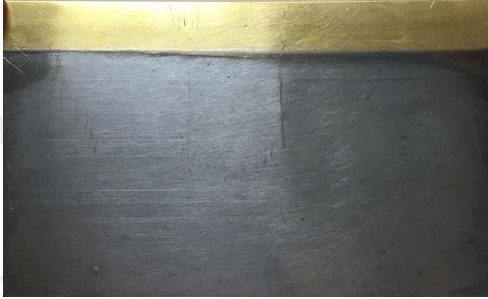
Şekil 4.44. 33 Numaralı kaplama bileşime ait Hull hücre testi
