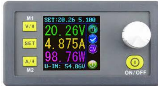
Şekil 3.4. Sabit akım kaynağı Dps-5005 0-50V 5A modülü
