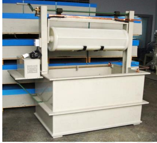
Şekil 2.8. Dolap kaplama banyosu
