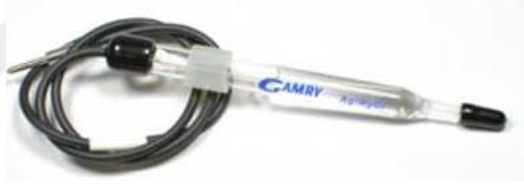
Şekil 3.3. Gamry marka Ag/AgCl referans elektrot
