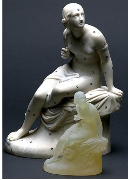
Şekil 38:Tarama yapılmış bir heykelin aslı ve RP yöntemiyle photo polimerden üretilmiş kopyası (www.cyberfx.com)
