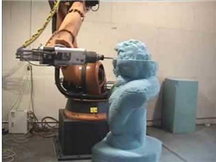
Şekil 39: Tek kollu bir CNC aletinde blok bir malzemedan heykel yapımı ( http://video-hned.com )
