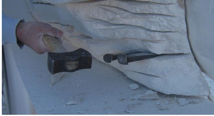
Şekil 16: Düz kama kullanımına örnek
