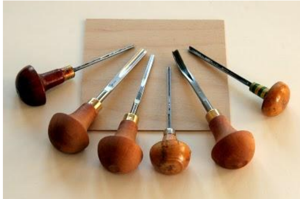
Şekil 20: Ağaç oymada kullanılan U ve V şeklindeki oyma kesikleri
