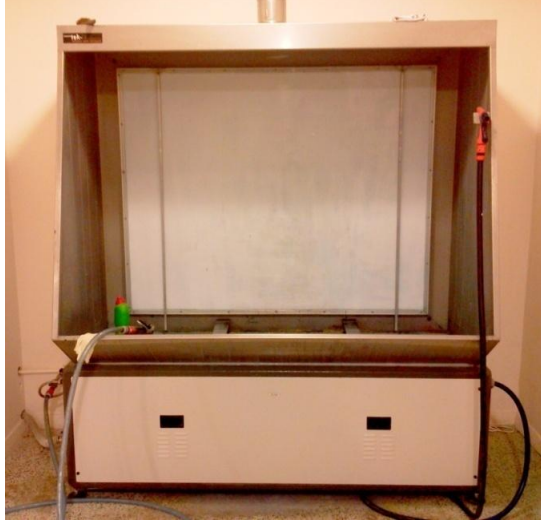
Şekil 13: Kalıp yıkama kabinleri
