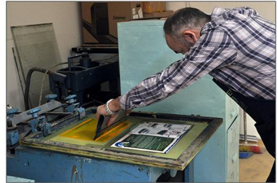
Şekil 33: Serigrafî masasında baskı işlemi
