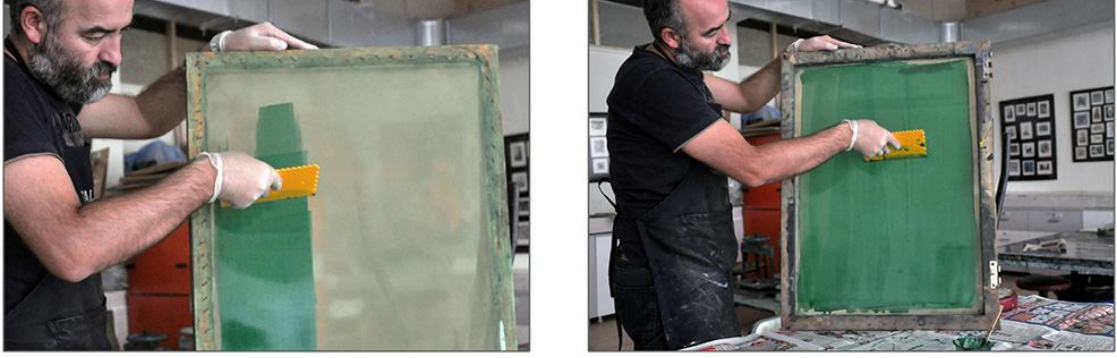
Şekil 31: Emisyonun kasmağa sürülmesi
