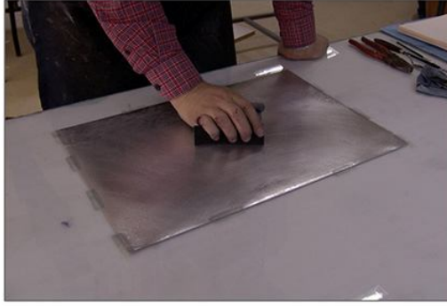
Şekil 78: Alüminyum folyo yüzeyinin hazırlanması
