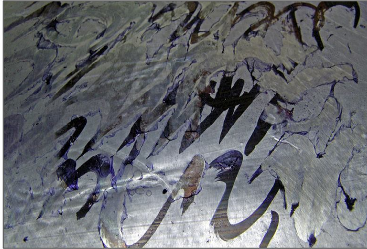
Şekil 84: Kalıbın silme aşamasında hasar görmesi
