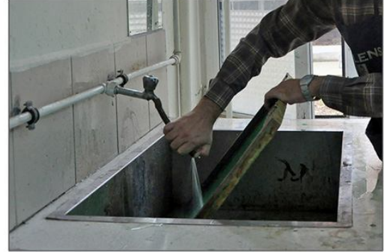
Şekil 32: İpeğin pozlanması ve basınçlı su ile kalıbın ortaya çıkarılması
