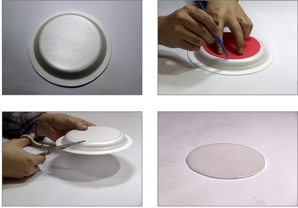
Şekil 53: Köpük tabağın baskı için hazırlanması
