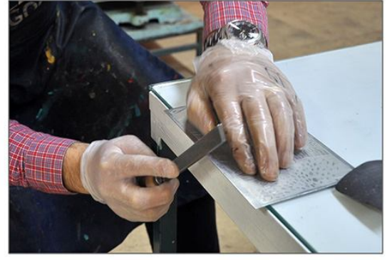
Şekil 24: Ziftten temizleme ve kenarlarını eğeleme aşaması
