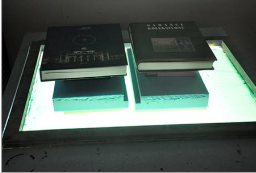
Şekil 32: İpeğin pozlanması ve basınçlı su ile kalıbın ortaya çıkarılması
