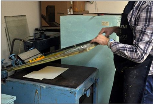
Şekil 33: Serigrafî masasında baskı işlemi
