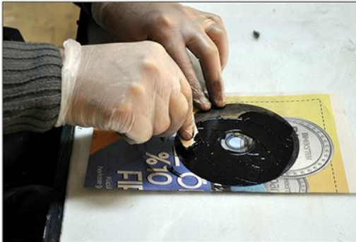
Şekil 92: CD üzerine boyanın verilmesi ve silinmesi.
