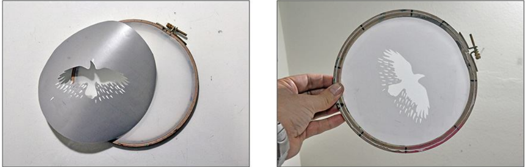
Şekil 103: Şablonun kesilip kasanağa yapıştırılması
