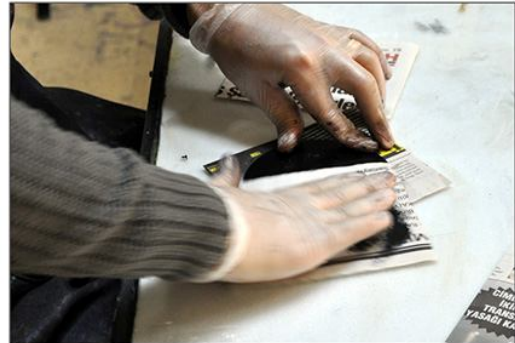
Şekil 92: CD üzerine boyanın verilmesi ve silinmesi.
