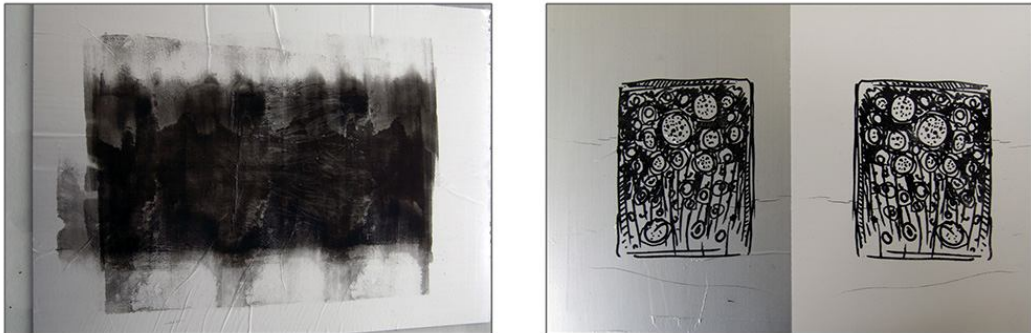
Şekil 86: Rulo folyoda baskı aşamasında görülen sorunlar.
